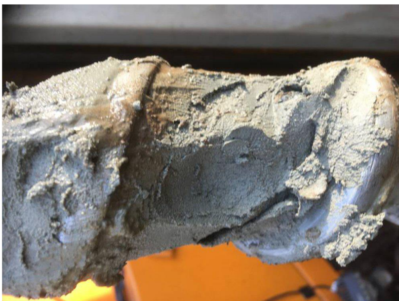
Figur 6 Posisjon B10 naverprøvetaking dybde 3-4 m.
