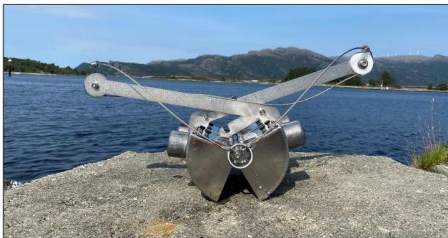
Figur 5. Van veen grabb for prøvetaking av sediment.
