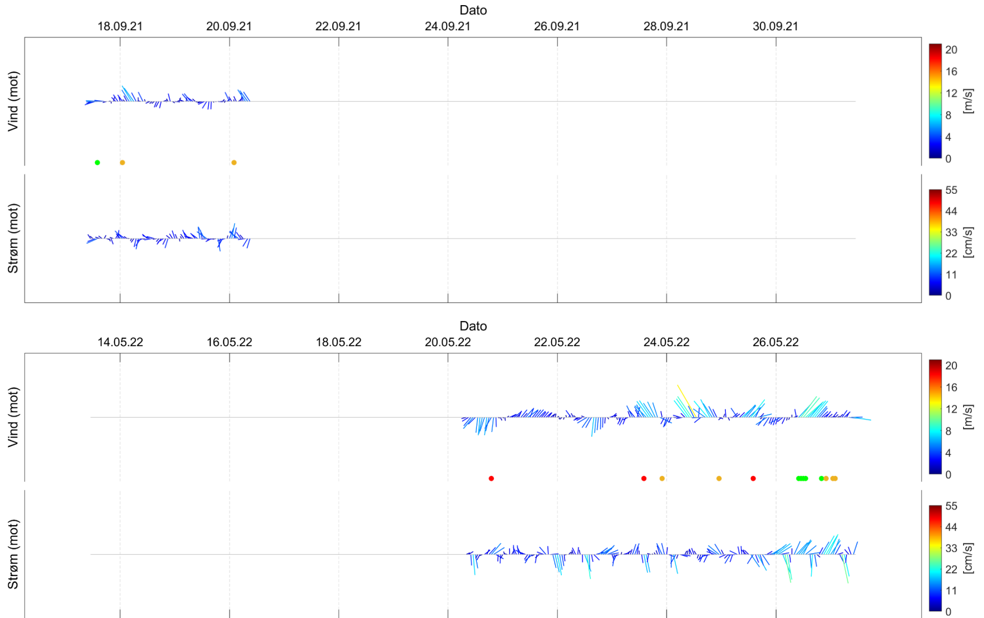
Figur 9.15. Fyrstikkdiagram av vindhastighet (mot retning) på Hitra-Sandstad II værstasjon (over) og strømhastighet (mot retning) på 5m dyp (under) under måleperioden.
